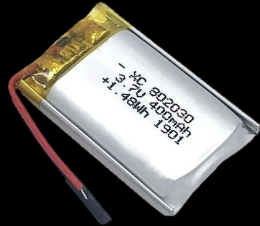
Bateria de 400mAh utilizada no projeto
